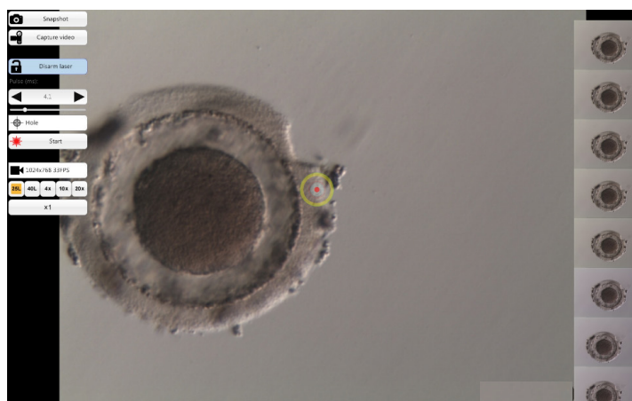
Fig. 23 : Le mode de fonctionnement de NaviLase pour percer des trous individuels à une position choisie
