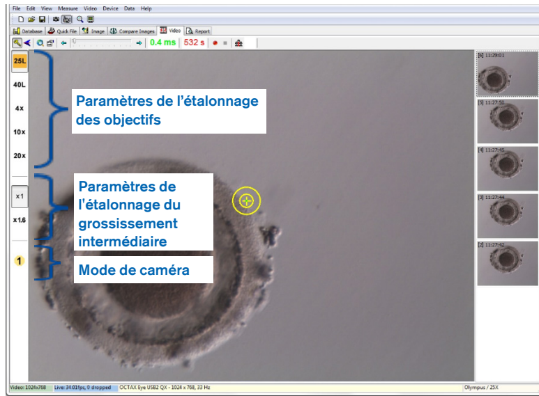
Fig. 17 : Affichage des paramètres de l'étalonnage des objectifs et des objectifs et le mode caméra dans la barre latérale gauche
