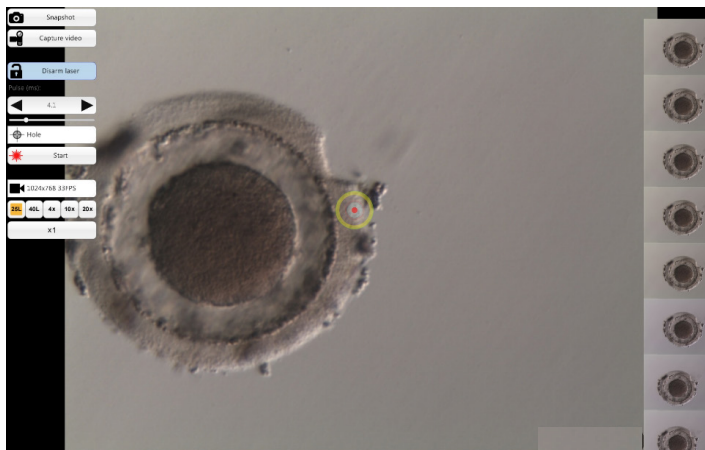
Abb. 23: NaviLase-Betriebsmodus zum Bohren einzelner Löcher an einer beliebigen Position
