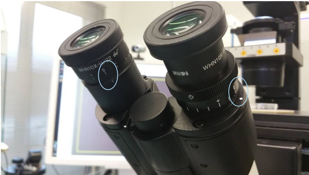
Εικ. 56: Προσαρμογή δίοπτρου (παράδειγμα: ανεστραμμένα μικροσκόπια Olympus)
