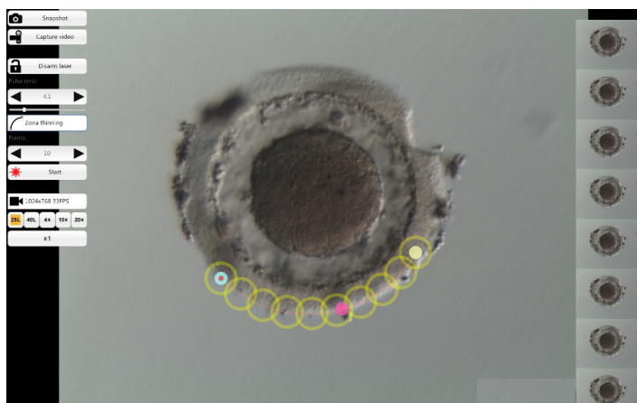
Εικ. 25: Ο τρόπος λειτουργίας του NaviLase για τη διάνοιξη οπών κατά μήκος προκαθορισμένης καμπύλης γραμμής
