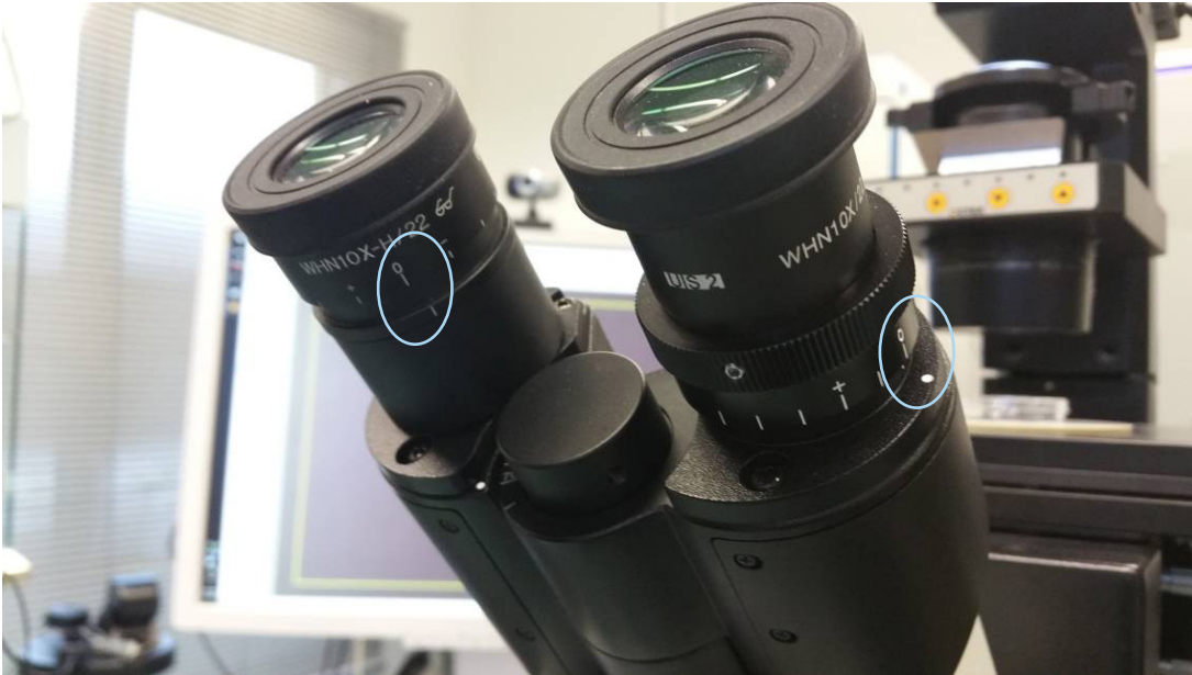
Fig. 56: Regolazione del diottro (esempio: microscopi invertiti Olympus)
