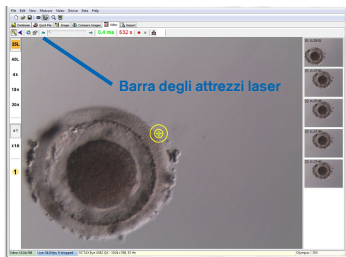
Fig. 12: Pagina Video di EyeWare con barra degli attrezzi laser e reticolo di puntamento del laser
