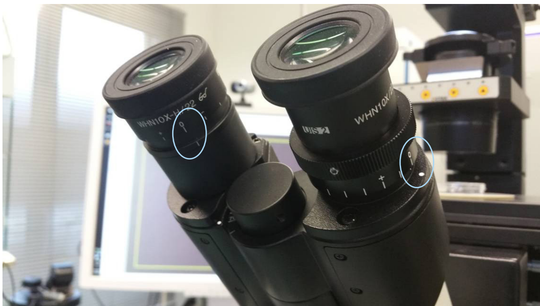
Rys. 56: Regulacja dioptrii (przykład: mikroskopy odwrócone Olympus)
