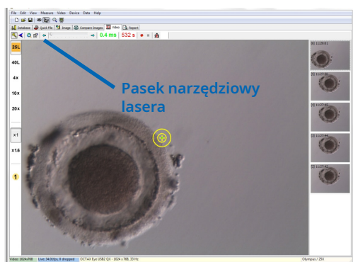
Rys. 12: Strona Video (Wideo) w oprogramowaniu EyeWare z paskiem narzędziowym lasera i celownikiem funkcji celowania laserem
