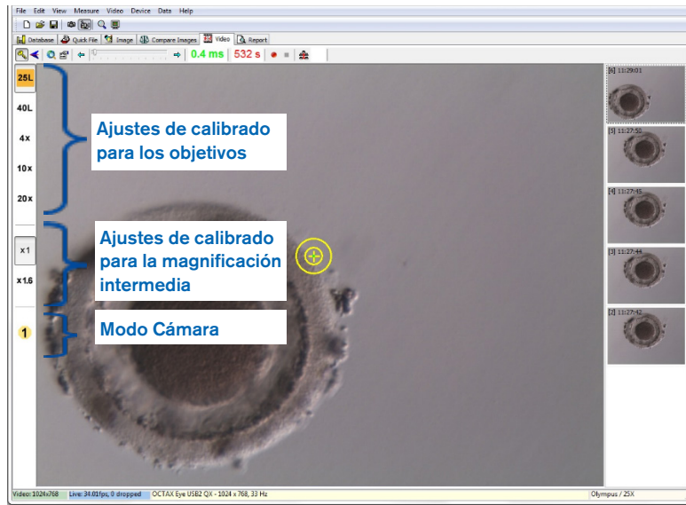
Fig. 17: En la barra lateral izquierda se muestran los ajustes de calibrado para los objetivos y para la magnificación intermedia, así como el modo Cámara.
