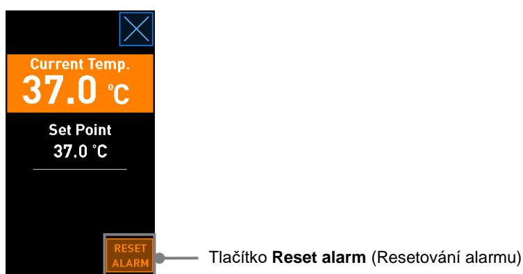
2. Stiskněte tlačítko **Reset alarm** (Resetování alarmu). Nyní se zobrazí domovská obrazovka inkubátoru.
