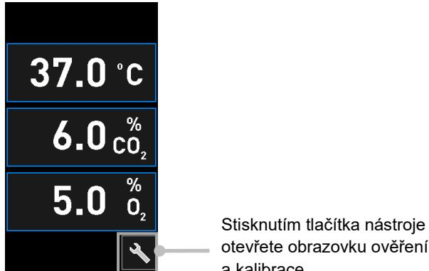
Ověřování můžete zahájit stisknutím tlačítka **CO<sub>2</sub> and O<sub>2</sub>** (CO<sub>2</sub> a O<sub>2</sub>), **Temp. Sensor A** (Teplotní senzor A) nebo **Temp. Sensor B** (Teplotní senzor B).
