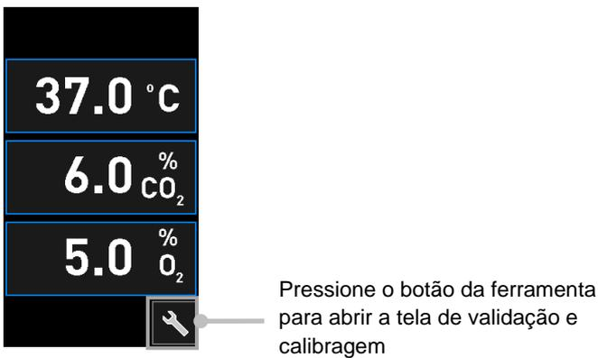
Você pode iniciar a validação pressionando **CO<sub>2</sub> and O<sub>2</sub>** (CO<sub>2</sub> e O<sub>2</sub>), **Temp. Sensor A** (Sensor de temperatura A) ou **Temp. Sensor B** (Sensor de temperatura B).
